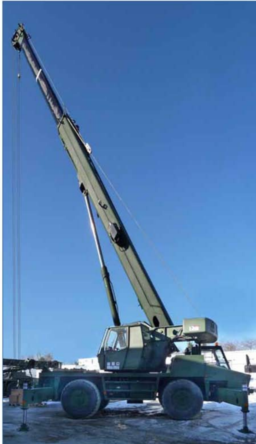
Lift Test 20 Ton Krupp Crane
